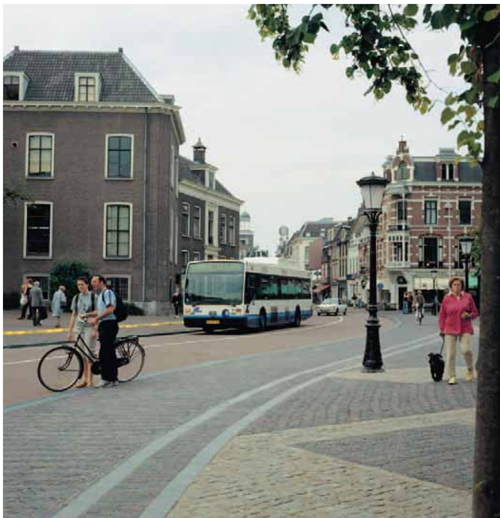
Herkenbaarheid van de HOV-baan in het centrum van Utrecht, door de eigen kleur
