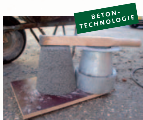
Aardvochtige betonspecie wordt toegepast bij machinale verwerking
