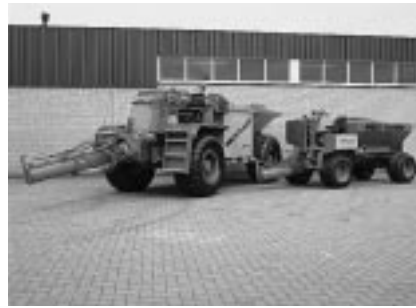
Foto 56 - 57: Betondumper met inhoud van 2,5 m 3 , capaciteit 20-60 m 3 /uur
