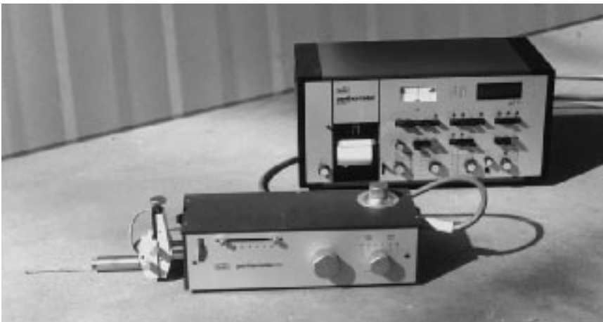
Foto 4: Instrument om de ruwheid te meten (Perthometer®)
